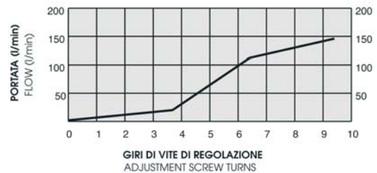
GRAFICO PORTATE PER SILENZIATORI REGOLATI 1/4" A 0,254 bar TYPICAL FLOW TEST GRAPH FOR 1/4" RESTRICTOR 0.254 bar
